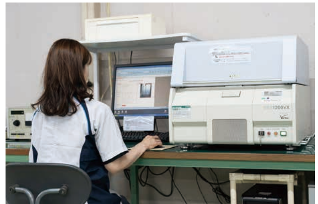
含有成分の実測（エネルギー分散型蛍光X線分析装置）
