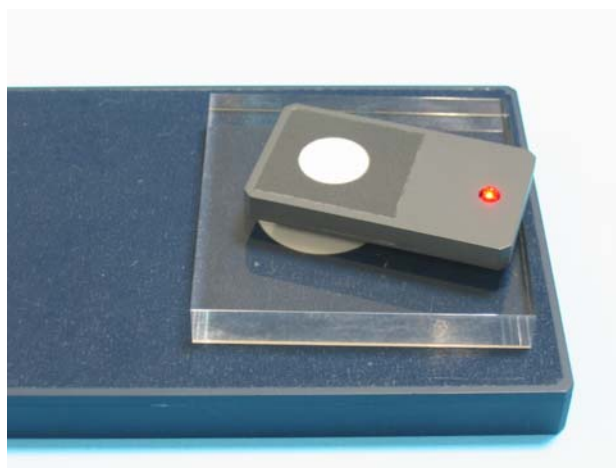
【受信器に電力伝送中 (LED点灯)】 (厚さ10ミリのアクリル板を挟んだ状態で点灯)
