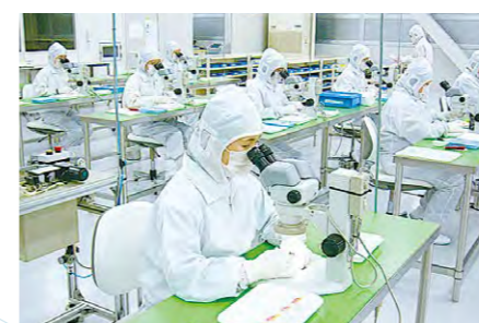
クリーンルーム内の検査 Inspection in a Cleanroom
