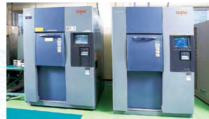
サーマルショック Liquid Type Thermal Shock Chamber
