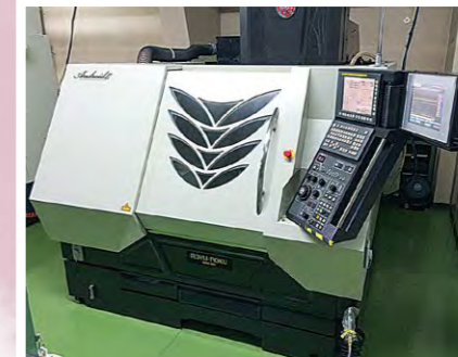
精密工作機械による金型製作 Jig Grinding Machine used in Precision Mold Processing
