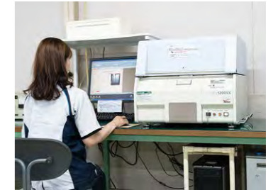
エネルギー分散型蛍光X線分析装置 Energy Dispersive Fluorescent X-ray Spectrometer
