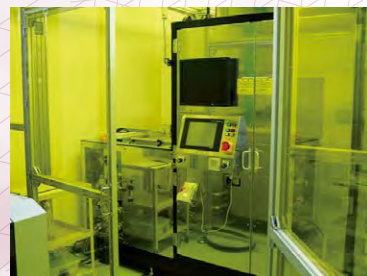
コンタクト露光装置 Contact Aligner
