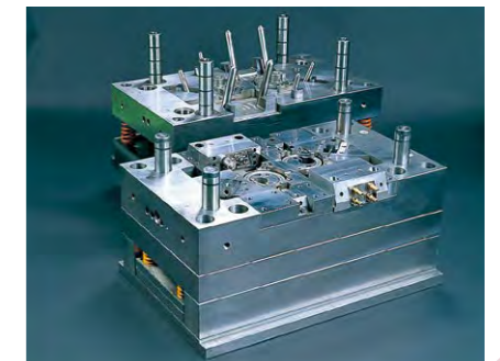
精密樹脂成形金型 Precision Molding Die
