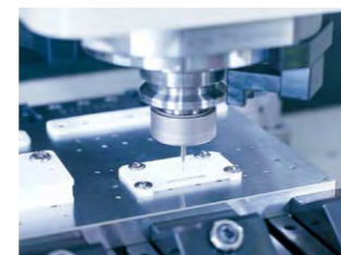
セラミック材への微細穴明加工 (ドリル直径φ 0.040mm) Micro Drilling for Ceramic Parts
