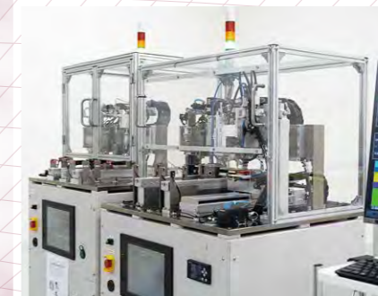
プローブ組立機 Probe Assembly Machine
