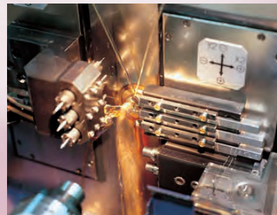
微細旋削加工 (加工外径φ 0.015mm) Precision Machining Turning Process (Outer Diameter : φ0.015mm)
