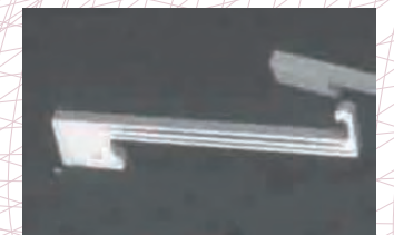
マスキング / フォトリソグラフィ / めっきを組み合わせたカンチレバー Cantilever processed using a combination of masking, photolithography, and plating
