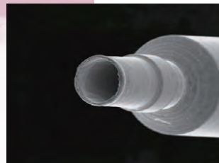
微細切削穴加工 (加工内径φ 0.03mm × 深さ 0.5mm) Extremely Small Hole by Drilling (Inner Diameter : φ0.03mm × Depth : 0.5mm)
