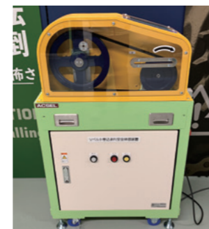
「安全道場」内に設置している巻き込まれ体感設備
