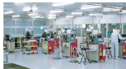
クリーンルーム内の部品加工
