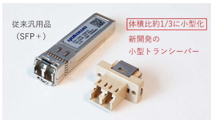
新開発 LC インターフェースを有する小型光トランシーバーと 従来汎用品 SFP+との比較
